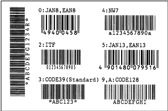
Beispiel des Testdrucks mit Barcodes.
